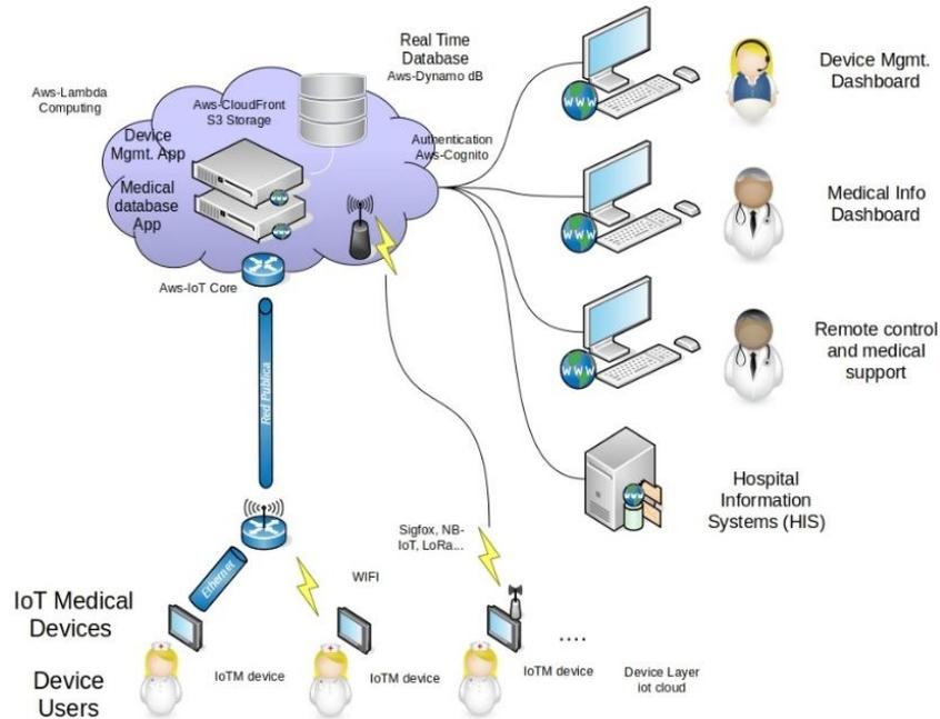
**Figure 1:** Arquitectura KiCloud que conecta varios dispositivos y permite el control remoto con fines de recalibración y actualizaciones automáticas
